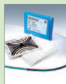
Prueba Bowie & Dick. Envase desechable. Para comprobar la esterilización en cargas porosas.
